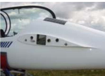
Aansluiting van de vleugel aan de romp van een DG-1000. Duidelijk is de profielvorm van de vleugelwortel zichtbaar.
