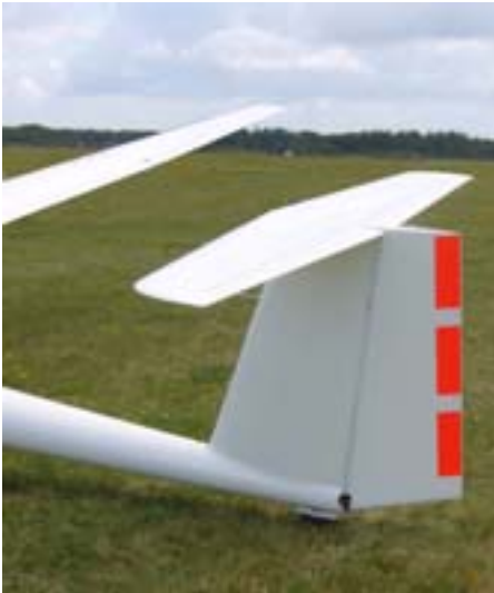
2.64 Stabulo met hoogteroer en kielvlak met richtingsroer.
