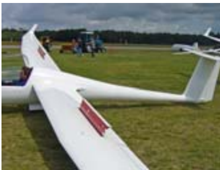
Enkelzijdige duikremkleppen in geopende toestand.
