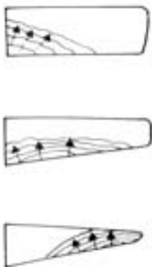
2.43 Invloed van de vleugelvorm op de plaats van overtrek.
